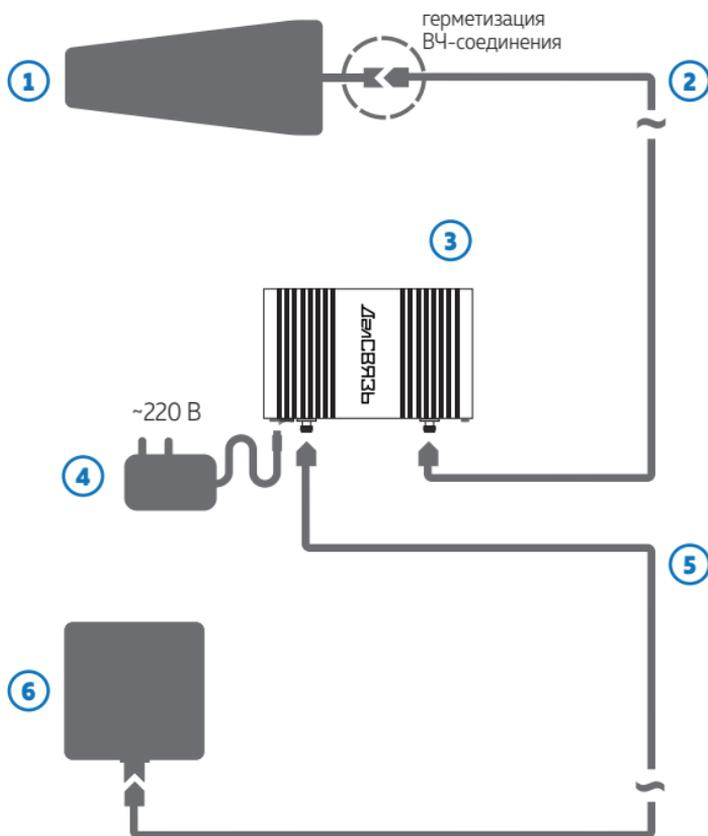
Рисунок 5 - Схема соединений
