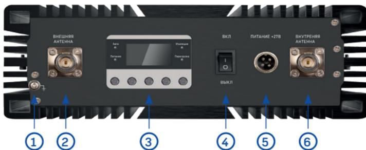
Рисунок 1 - Передняя панель устройства
